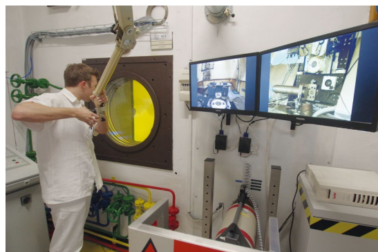
Horká komora pro spektrometrické analýzy ozářených materiálů. Zdroj: Archiv ÚJV Řež
